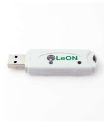
LeON est connecté à une alimentation USB 5 volts/1A puis via la page REDIRECT, soit lié avec http à un LoWi avec la même adresse IP fixe, soit lié à MQTT et lié au réseau WiFi. De cette façon, LeON reçoit le statut tarifaire de l'énergie via LoWi et affiche ce statut avec sa LED RVB : ROUGE : tarif de jour, BLEU : tarif de nuit, injection VERTE.
