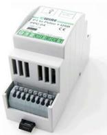
Le module PPC.04, ou le 'convertisseur port P1 en pulse' est un module autonome qui lit les lectures des compteurs du port P1 et le convertit en impulsions de consommation, ou qui transmet des lectures de compteurs en série à un port USB. Un système de domotique ou un enregistreur de données peut utiliser ce module pour lire les impulsions de consommation (import, export, gaz, tarif).
