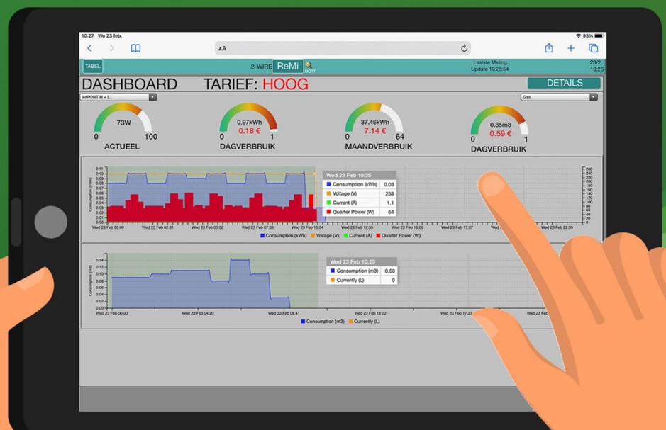
figure. Tableau de bord ReMI (tablette, smartphone ou PC) avec, entre autres, le taux et la consommation d'énergie actuels, des graphiques déroulants: par ex. électricité avec consommation de pointe et consommation de gaz.
