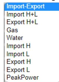
Peakpower. Cette puissance d'un quart d'heure est utilisée par l'opérateur de réseau pour mesurer le pic mensuel le plus élevé et ainsi calculer vos frais de réseau. Vous pouvez surveiller cette valeur mesurée
