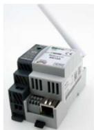
Le serveur web «MEGA» est un maître Modbus. Tous les esclaves Modbus sont connectés au bus RS485 et configurés avec l'adresse Modbus, le nom et le type de module. En plus des compteurs Modbus 2-WIRE (Electricity, Calorie, MoCo), des compteurs externes peuvent également être réglés via MQTT. Selon qu'il s'agit d'un MEGA16, MEGA32, MEGA64 ou MEGA128, 16, 32, 64 ou 128 canaux peuvent être configurés, dont
